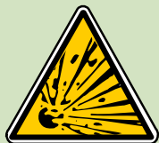
Matières explosives, risque d'explosion
